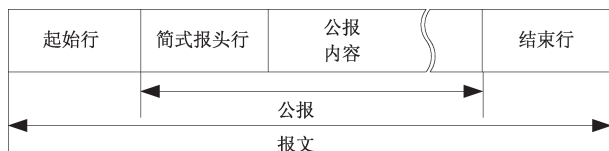
图 1 包含简式报头行的报文结构
